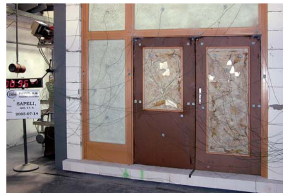
zkouška požární odolnosti – 35:21 min. (norma vyžaduje odolnost 30 min.)
