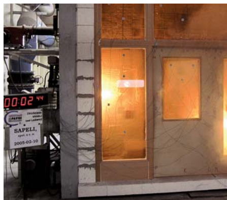
zkouška požární odolnosti – 2:45 min.
