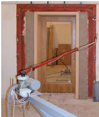
zkouška zvukově izolačních vlastností – jednokřídlé prosklené dveře
