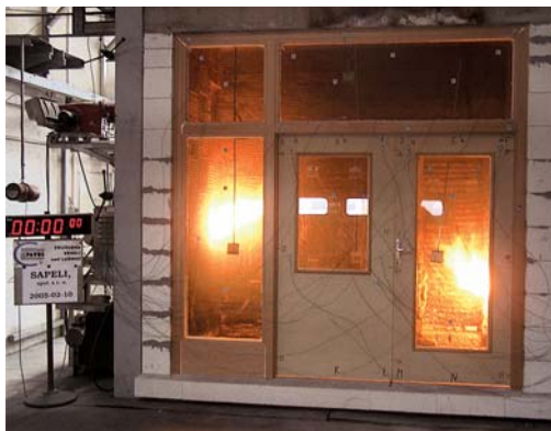
zkouška požární odolnosti – začátek
